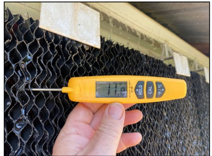
Figura 1. La temperatura del agua fluyendo a través del panel se convertirá en temperatura de bombillo húmedo pronto después de ser ingresada en la parte superior de este.
