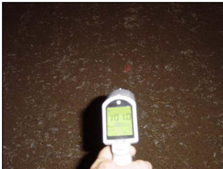
Figura 3. Termómetros sin contacto vienen equipados con un apuntador láser
