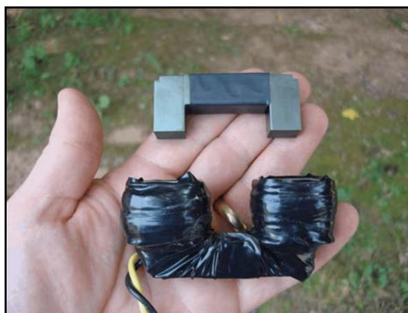
Figura 3. Transformador tipo split-core.
